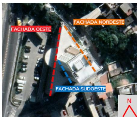
Figura 4 - Análise da orientação e irradiância solar das fachadas do edifício
