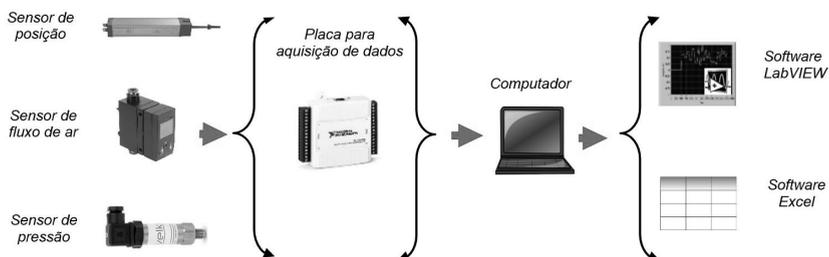
Figura 8 - Sistema de aquisição de dados para obtenção dos resultados
