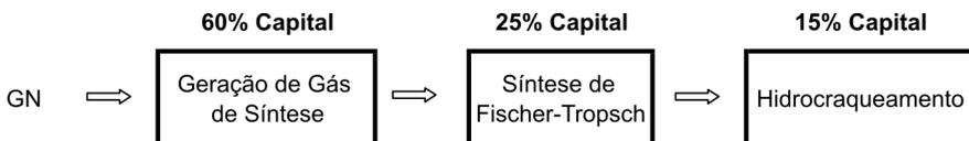
Figura 2 – Alocação do CAPEX nas diversas etapas do processo industrial GTL
